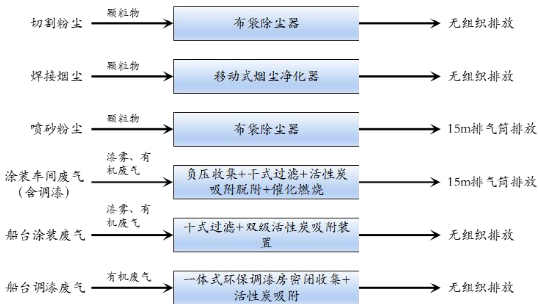
图6.2-1 本项目废气处理措施示意图
