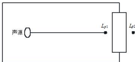
图4.4-1 室内声源等效为室外声源图例
