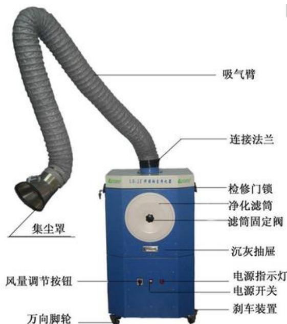
图6.2-2 移动式烟尘净化器示意图
