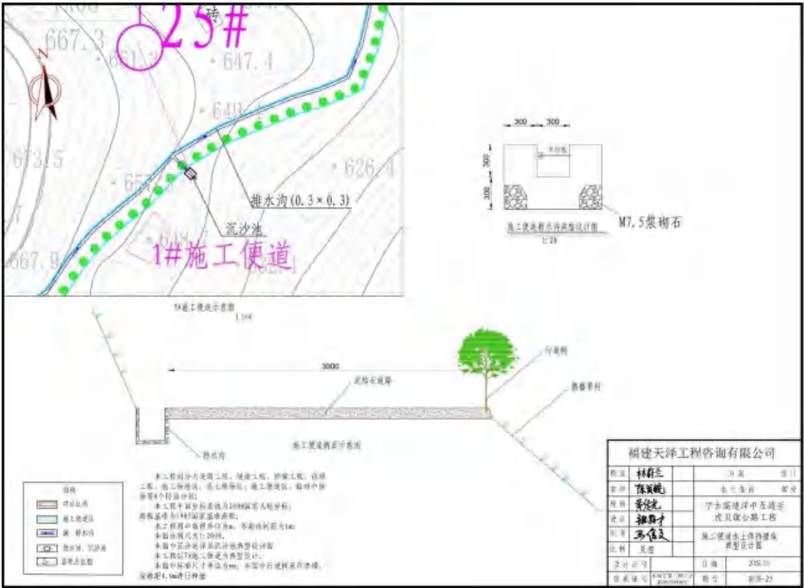
图6.1-5 施工便道水土保持措施典型设计图
